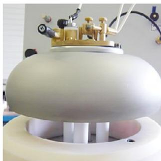
Il sistema di riscaldamento permette una eccellente trasmissione del calore riducendone la dispersione. La potenza del riscaldatore è di circa 420W consentendo di ottenere temperature maggiori di 370°C.
