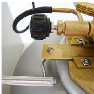
Sistema automatico di apertura, chiusura e posizionamento dell'otturatore.
