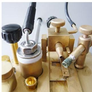
I componenti del sistema di detezione garantiscono eccellenti prestazioni nei risultati e nella ripetibilità. La quantità di campione (2 ml / 4 ml) viene iniettata nella coppa tramite l'orificio di riempimento.
